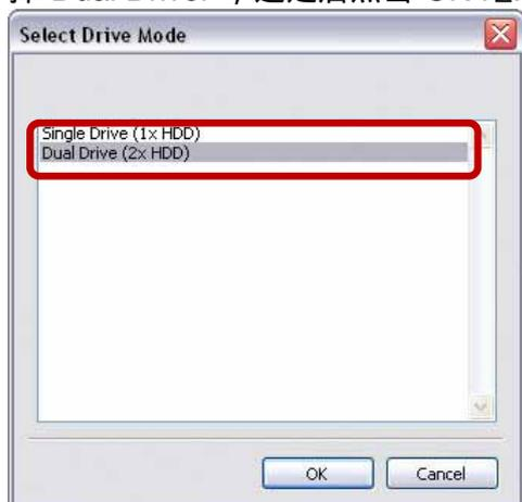
7. 如果已经安装了两个硬盘，选择了“Dual Driver”模式。对于数据安全性有要求，选择的 RAID 1（镜像模式）；最大限度利用存储容量，选择 BIG（串连模式）；点击“OK”继续。
